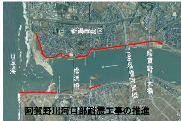
対策をしていない堤防は液状化により沈下・破堤する危険性があり、破堤すると津波や洪水が居住地に流入し、大きな被害が発生する。
