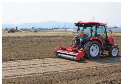
自動運転トラクタによる播種床づくり
