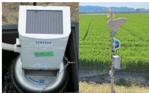
自動給水栓・水田センサー
