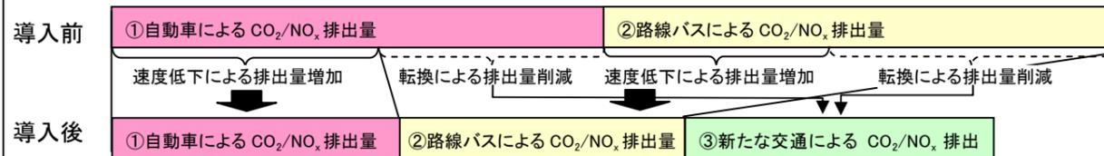
CO<sub>2</sub>, NO<sub>x</sub>排出量変化の算出手順
