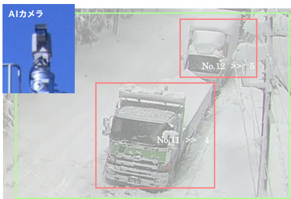
AIカメラによる車両滞留の自動検知システム (国道8号(福井県あわら市))
