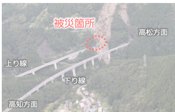
上下線の被災を免れた高速道路の分離構造 (高知自動車道(高知県大豊町))
