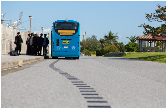
幹線道路上に磁気マーカー等を設置し実施された 自動運転バスの実証実験 (沖縄県那覇市・豊見城市) 出典：内閣府資料
