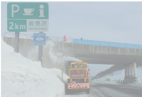
準天頂衛星を活用した除雪車運転支援システム※ (道央自動車道(岩見沢～美唄間))
