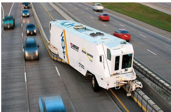
利用時間帯や交通状況に応じた 可変式道路構造：リバーシブルレーン (アメリカ合衆国テキサス州)
