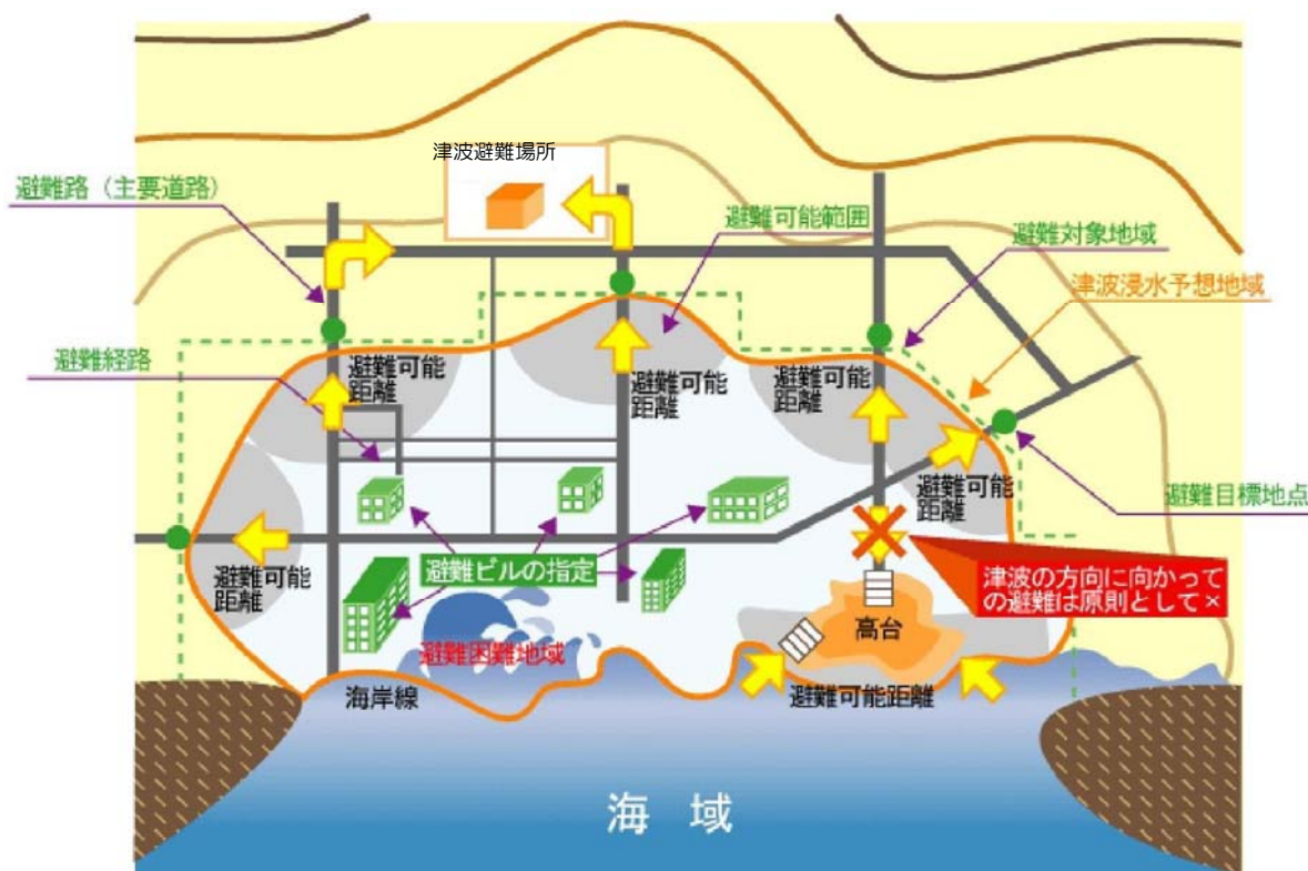
※避難困難地域設定の概念図（出典：津波避難ビル等に係るガイドライン）
