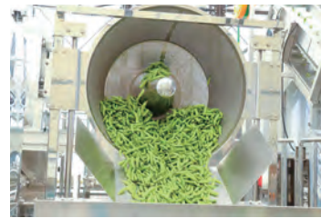
洗浄後の脱水機
