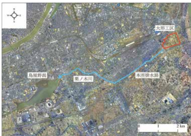
図 2.4 大形工区から鳥屋野潟への排水流入経路
