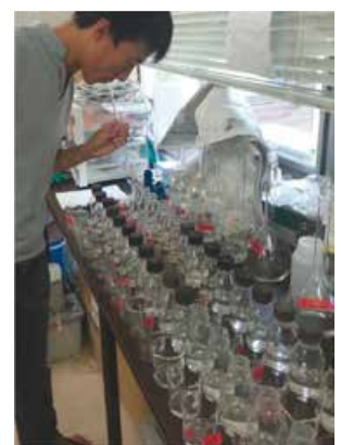
写真 3.6 T-P 濃度測定のための試料調製作業
