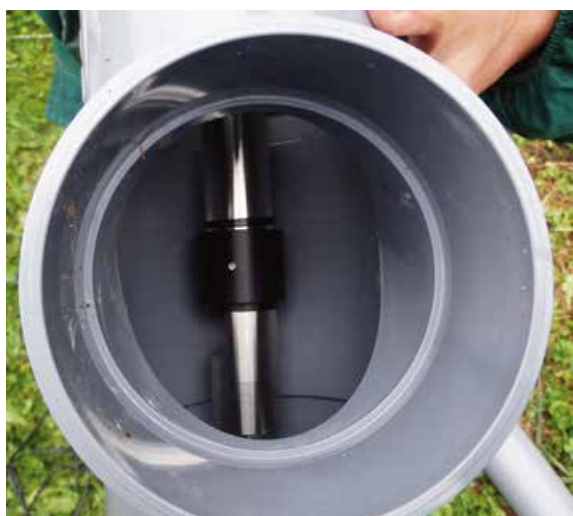
写真 3.2 濁度センサー
