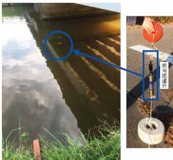
写真4.4 流向流速計の設置位置
