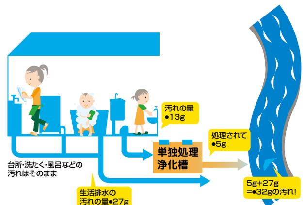
■図-14 単独処理浄化槽の排水処理
