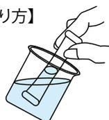
①チューブに水を吸い込ませます。（チューブ内の薬品と反応して発色します。）
