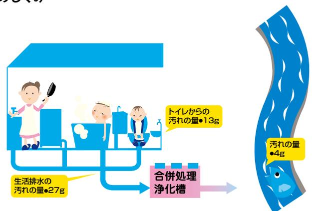
■図-13 合併処理浄化槽の排水処理
