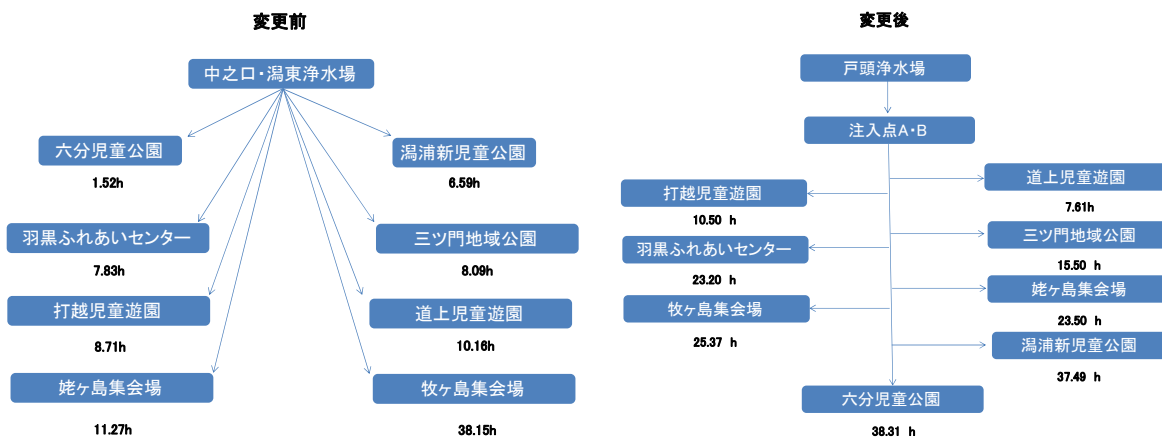
図-7 中之口・潟東浄水場給水区域切り替え後の流達時間
