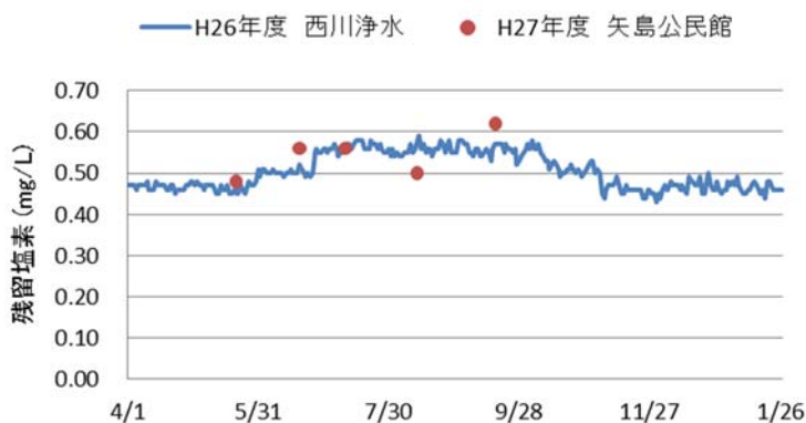
図-4 西川浄水場稼働時と廃止後の残塩比較
