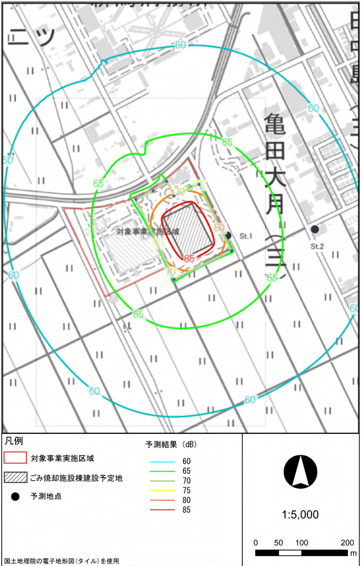
図 7.2.4 建設機械の稼働に伴う騒音予測結果 (建設機械の寄与分 L_{A5} )
