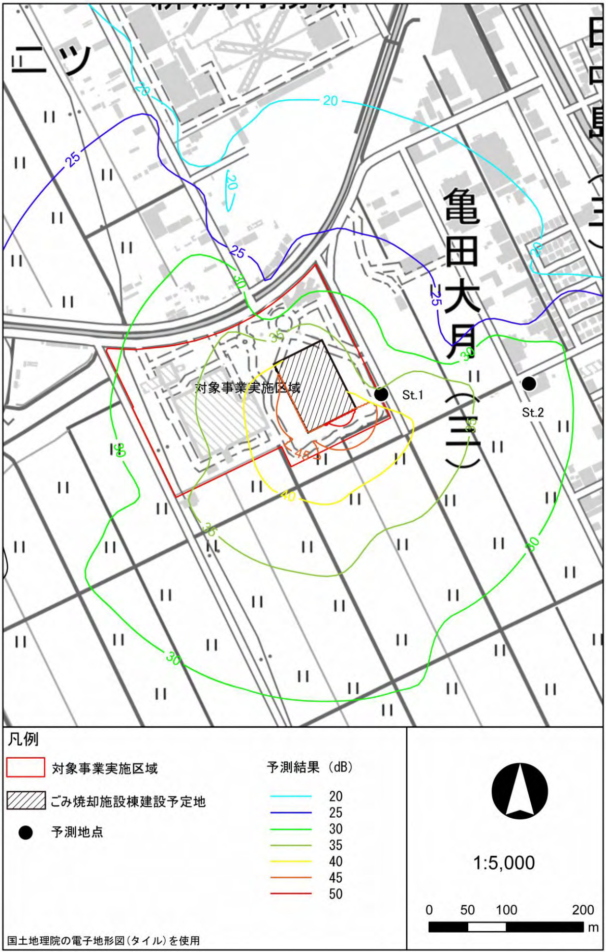
図 7.2.10 施設の稼働に伴う騒音予測結果（施設の稼働による寄与分； L_{A5} ）
