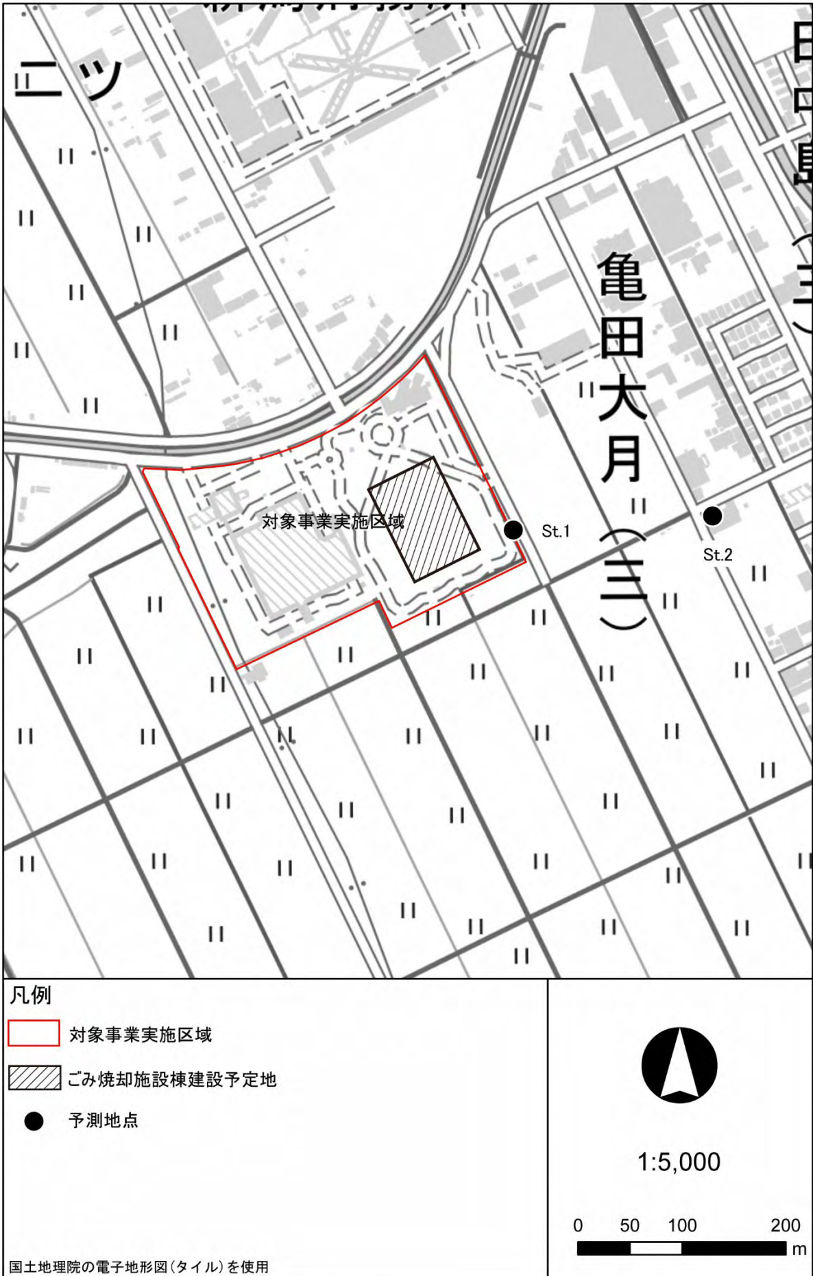
図 7.4.3 予測対象時期における建設機械の稼働範囲と予測地点の位置図
