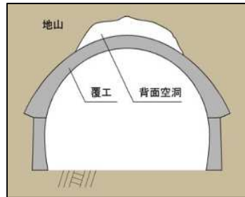
背面空洞位置、規模を確認する新技術
