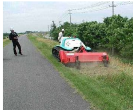
堤防除草(大型ラジコン草刈り機)
