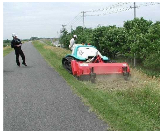
堤防除草(大型ラジコン草刈り機)
