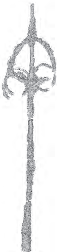
江南区曾我墓所遺跡出土鉄製錫杖のX線CT画像合成写真（奈良時代） （新潟県工業技術総合研究所作成）
