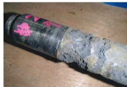
ポンプ主轴の腐食
