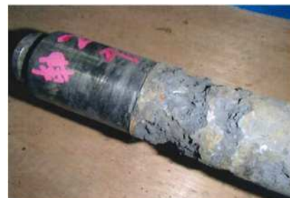
ポンプ主轴の腐食
