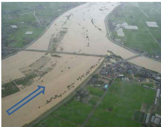
平成23年7月豪雨時、計画高水位を超えた 信濃川保明新田観測所付近
