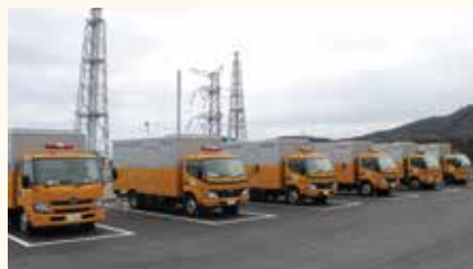
女川原子力発電所に配備した電源車6台（出力1台：400kVA）
