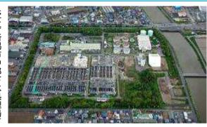
一般家庭や事業所等から排出される汚水及び雨水を排除するための排水管、排水施設、処理施設、ポンプ施設及びその他施設から構成され、下水管により集められた汚水は終末処理場で処理された後、河川等に放流される。
