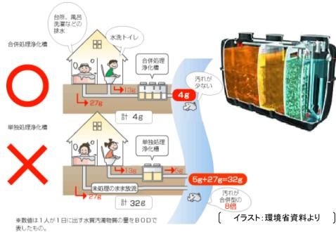
公共下水道や農業集落排水施設などが整備されていない地域で、 汚水を処理するための施設で、家屋や建物それぞれに設置される。 合併処理浄化槽は台所、風呂、洗濯などの生活雑排水とし尿を処 理する。一方、単独処理浄化槽はし尿のみを処理する。汚泥が堆 積するため定期的な清掃が必要。
