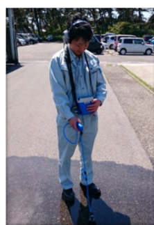
水道管は地面の下だから、水がもれてもどこで穴があいているのかわかりません。音を聴いて穴の場所を探します。
