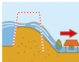
沿川地域：地震の揺れによって、堤防等が倒壊し、津波の発生前でも、河川からの浸水が発生します。続いて、津波が河川を遡上(そじょう)し、強い力で堤防を破壊し、被害が、さらに拡大する恐れがあります。
