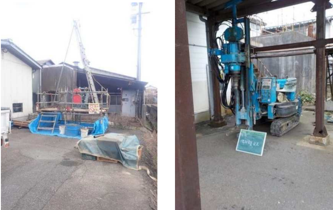
写真 2-3-1 ロータリー式ボーリングマシン（左）及び振動式マシン（右）による試料採取例
