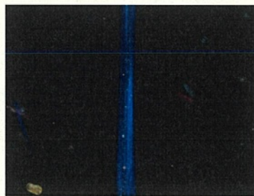
アモサイト (屈折率 n_D^{25^\circ\text{C}} :1.680)
