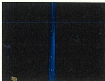
アモサイト (屈折率 n_D^{25^\circ\text{C}} :1.680)
