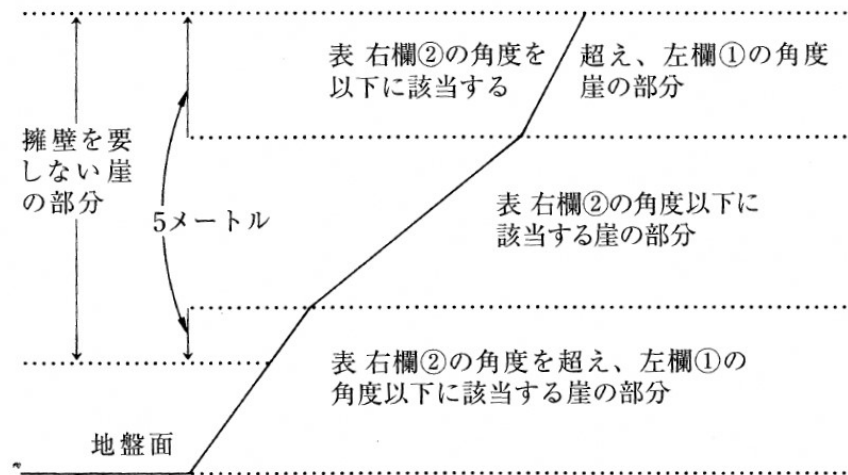
図 2.1.1 擁壁を要しない崖又は崖の部分 (出典:盛土等防災マニュアルの解説 I p.307)
