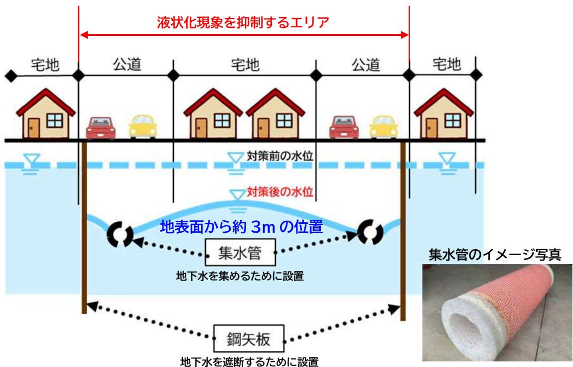
地下水位低下工法のイメージ図（断面図）
