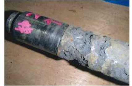
ポンプ主轴の腐食
