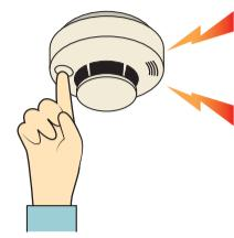
作動点検は、同警報器の点検用ボタンを押すか、ひもを引くだけでできます。ブザー音や音声で異常の有無を知らせてくれます。
