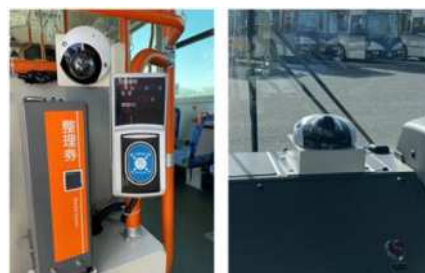
バス車両に取り付ける AI カメラ
