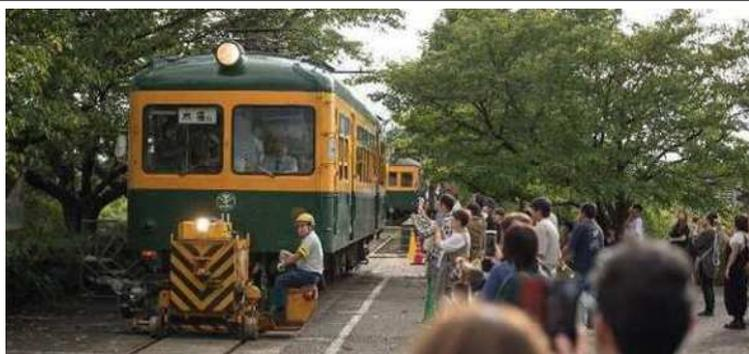
車両移動機「アント」牽引で走行します
