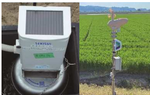
自動給水栓・水田センサー
