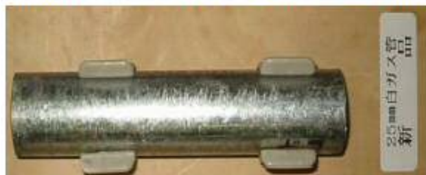
埋設前の白ガス管(鋼管に亜鉛メッキを施した管)
