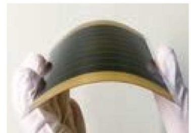
出典：先端研マスターブック 2025 「瀬川研で開発した変換効率 20%を超えるペロブスカイト太陽電池フレキシブルミニモジュール」
