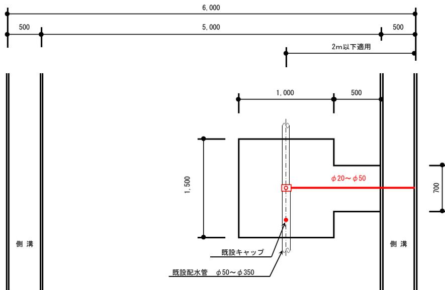
適用 給水管の修理 分岐部からの入替
