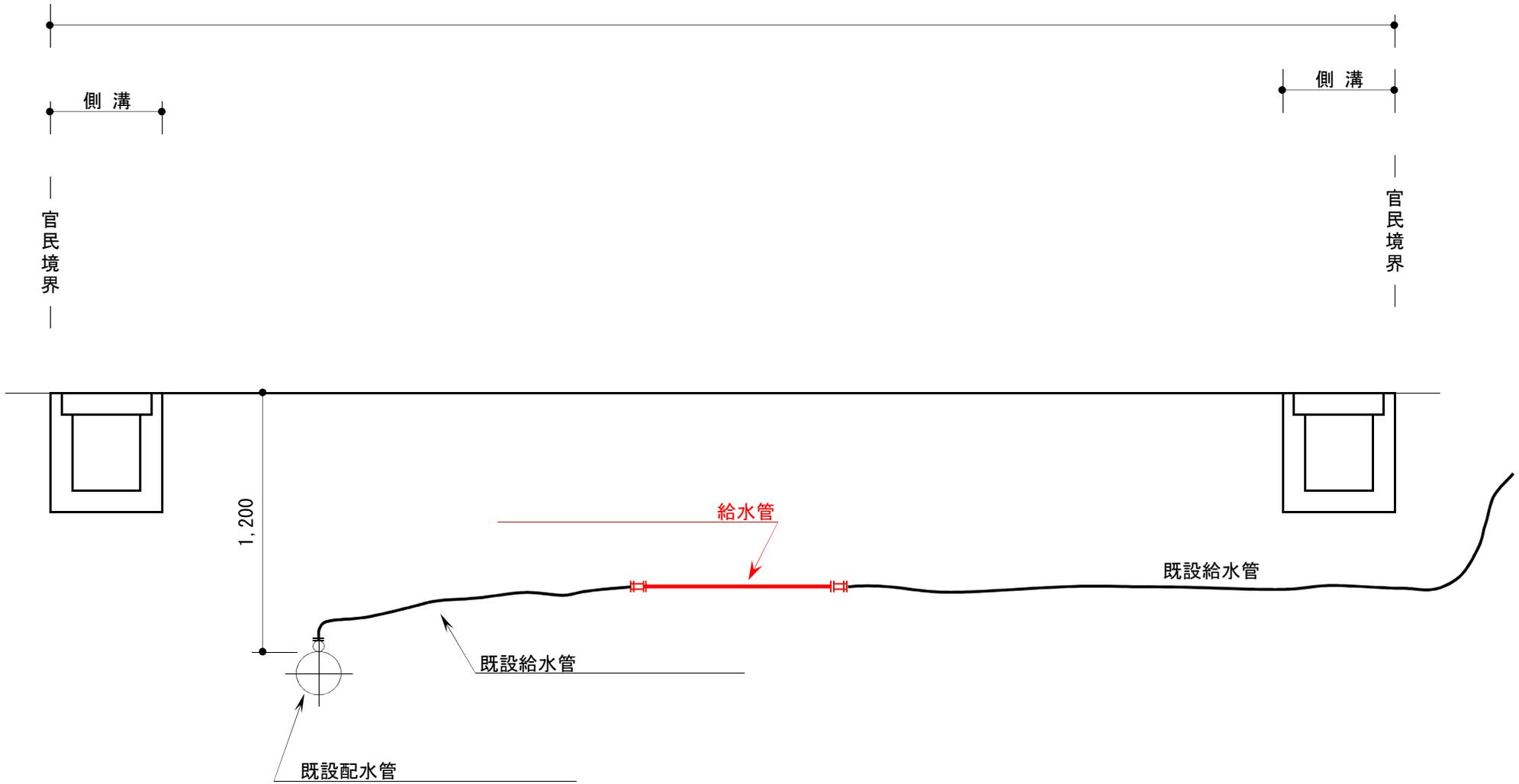
修宅1~2 給水管修理工 (標準施工図)
