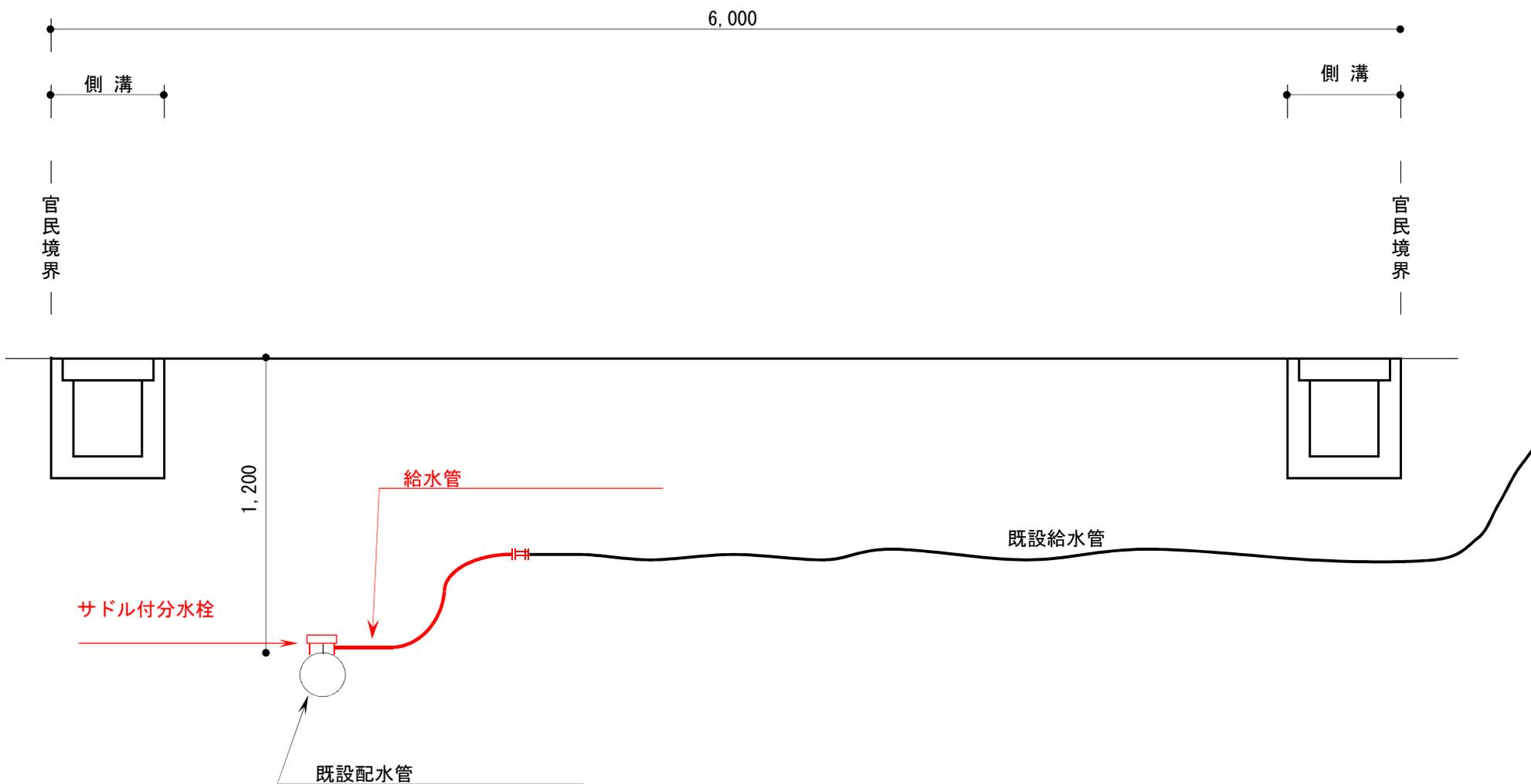
修部5~8 給水管修理工(標準施工図)
