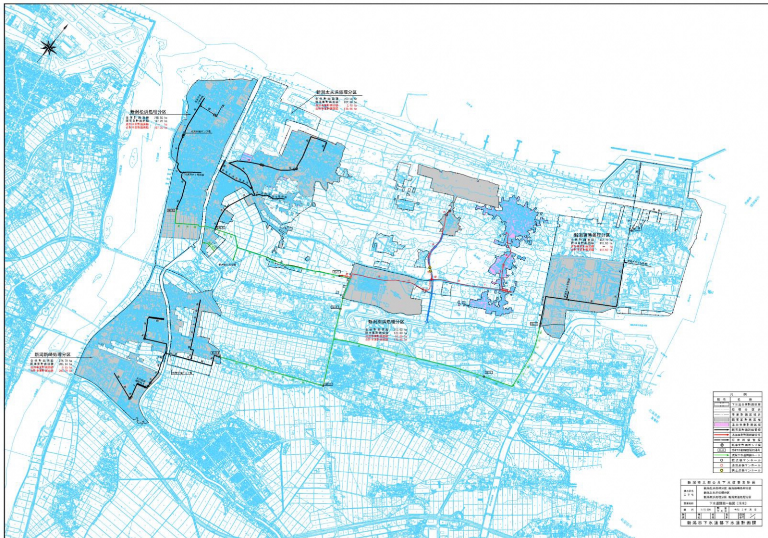
出典：令和3年度 阿賀野川流域下水道（新井郷川処理区）関連新潟市北部公共下水道 事業計画変更協議申請書 図表 3.1-12 北部処理区下水道計画一般図（雨水、東部地区）
