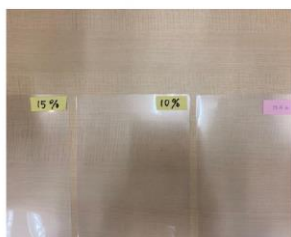
<クリアホルダー> 配合率10%、15% 右端はバージン材100%です。
