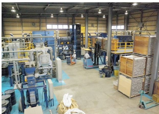
蛍光灯の選別・仕分け・破碎等 (有害物質である水銀を安全に回収)
