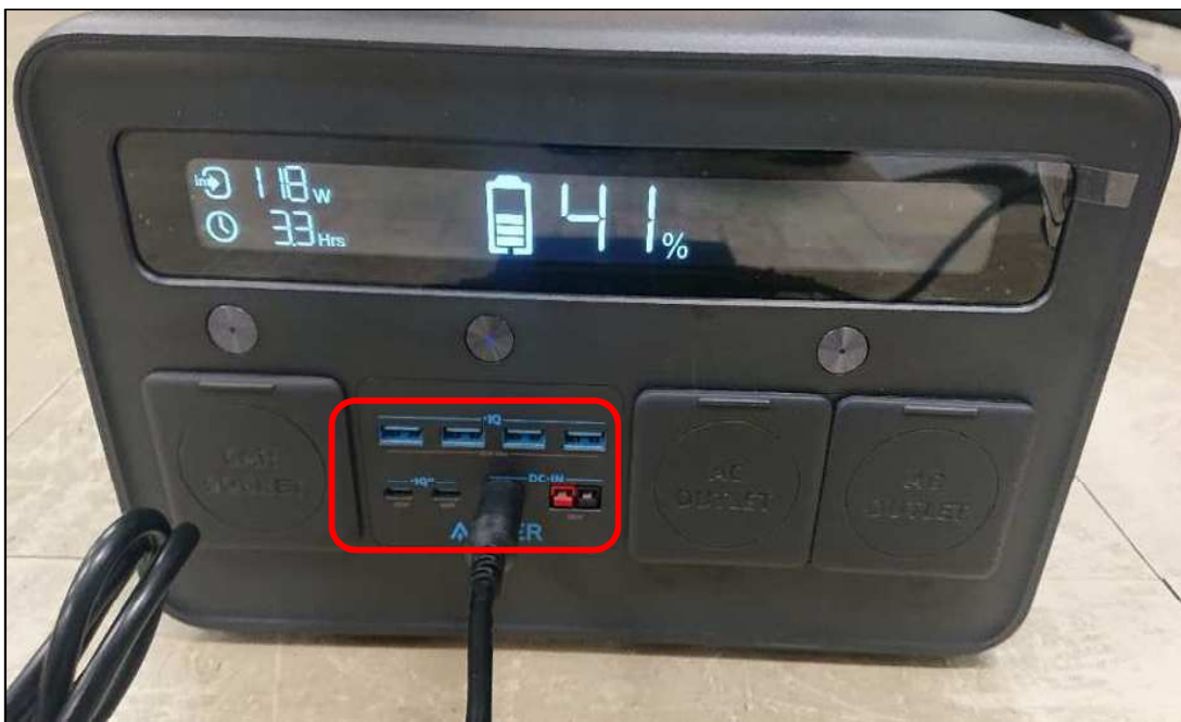
⑧ 差込口は図の通りです。 充電が始まると、液晶画面に各種情報が表示されます。
