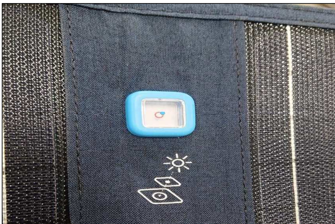
④ ソーラーパネル側の日時計の青い●の影が、背景の赤い丸の中に入るように、設置位置を調整します。
