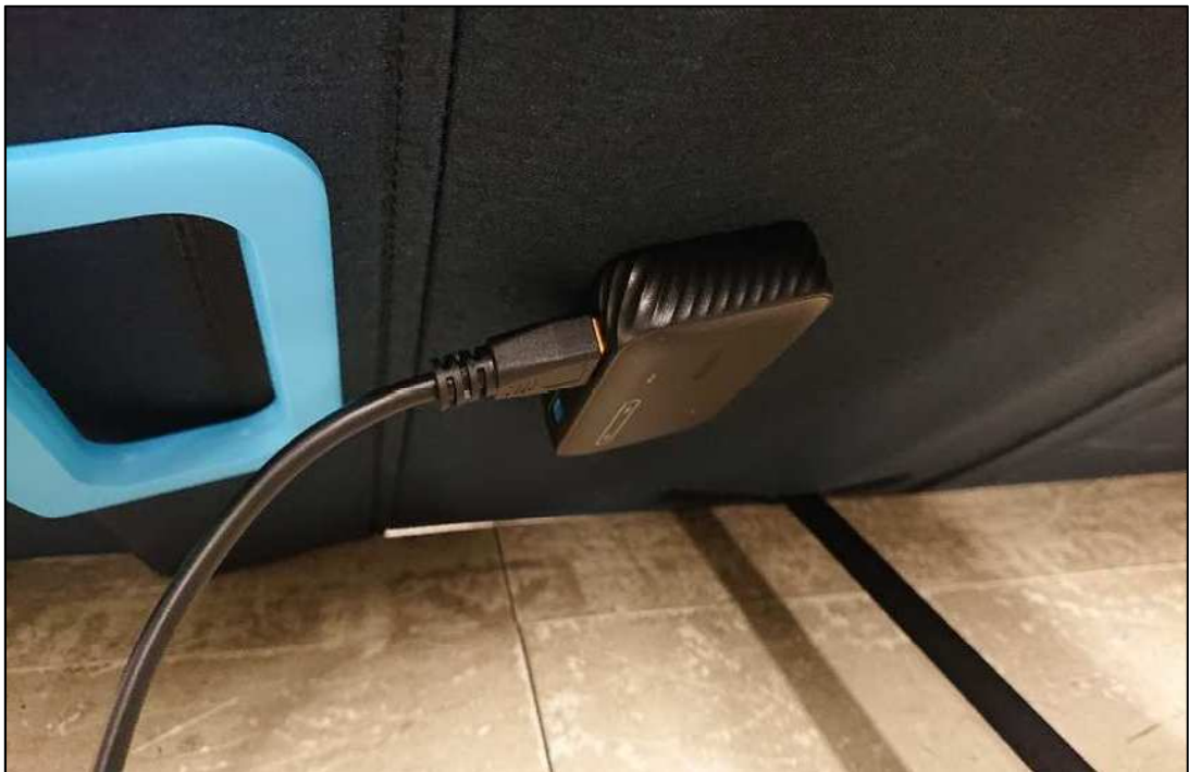
⑥ ケーブルの黄色い端子側を、充電装置の黄色い差込口へ接続します。
