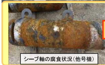
新潟大堰 主ゲート ワイヤロープシーブ(滑車)の交換
