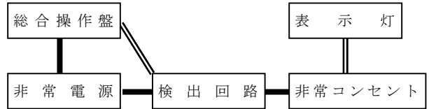
(12) 非常コンセント設備 ★
