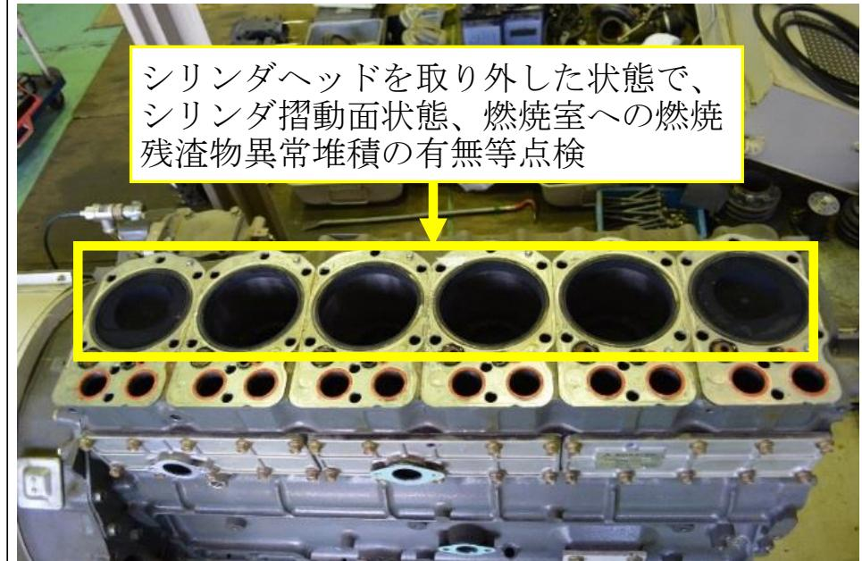
・シリンダヘッドを取り外し、シリンダ摺動面等の内部を確認する。
