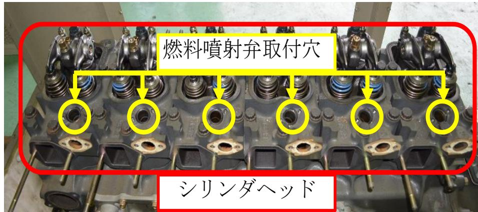
写真では吸気ダクトも取り外された状態を示している
