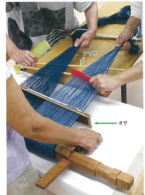
写真89 2人でクシを使い、糸を整えながら移動していく。アヤ竹やオサを動かす時に引っかかりを感じたら強く動かさない
