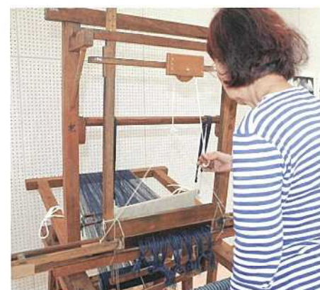
写真159 紐の先の小さな板を手で引くと、左右のヒバシリが内側に引き寄せられ、この寄せる力で杼を送り出す
