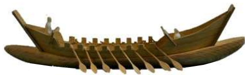
道正遺跡の準構造船の復元模型
