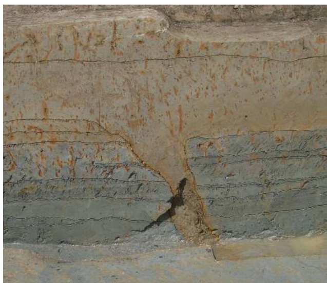
三条地震（1828年）の液状化によると推測されている噴砂（秋葉区大沢谷内遺跡）
