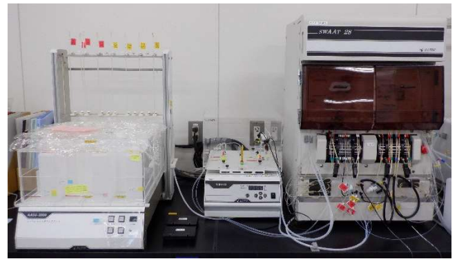
オートアナライザー:液体の検体を流路内で発色反応させるなどして、自動で濃度を測定する装置。当研究所では全窒素や全リン等の測定に使用している。
