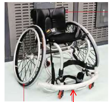
バンパーがあり、これにより脚が保護され、他の車いすに引っかからないようになる。
