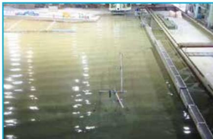
港全体の模型を平面水槽内で再現し、港に入ってくる波を小さくするには防波堤をどこに作るべきか調べます。
