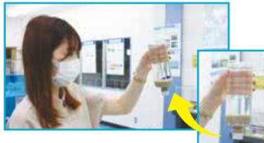
通常地面の土の粒子はしっかりとくっつき、隙間に水や空気が入っていますが、地震により土の粒子が離れてしまいます。粒子が離れることで地面が液状になり、重い建物は沈み、軽いマンホールは浮きます。この現象を、水と砂、1cmの球状のプラスチック(重り)を入れたペットボトルで実験。
