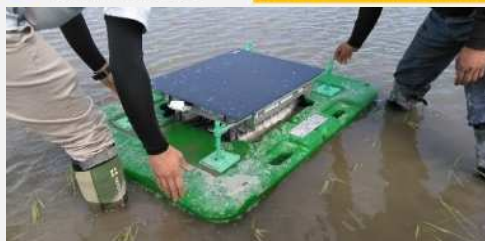
自動除草ロボット『アイガモロボ』
