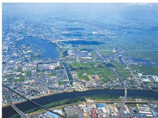
新潟市のほぼ中央に位置する亀田郷地区は、かつて「芦沼」と呼ばれるような湿田地帯でしたが、大規模な揚排水施設整備により乾田化されました。現在では、幹線・支線あわせて延長1,300kmにわたる水路が張り巡らされ、流域面積約110km<sup>2</sup>のうち、水田が約40km<sup>2</sup>を占め、人口約25万人を有する都市的農業地域となっています。
